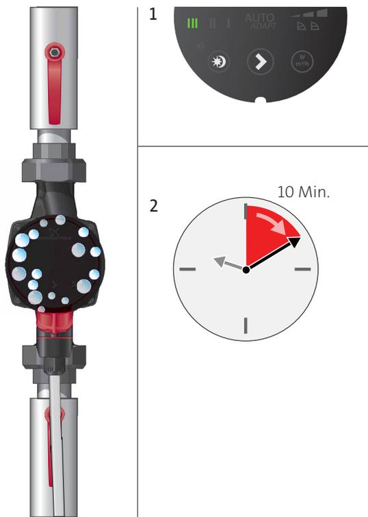
Рис. 25 Удаление воздуха из насоса
