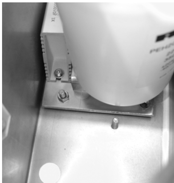
Рис. 38 Резистор R1 (ограничения пускового броска тока)
