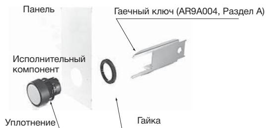
Рис. 4 Установка исполнительного компонента в отверстии диаметра 25,5 мм
