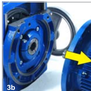
3b) Allentare le quattro viti che fissano il motore al variatore e sfilare il motore elettrico
