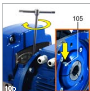
10b) Stringere la vite 105 del giunto per il serraggio dell'albero motore
