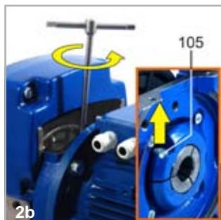
2b) Allentare la vite 105 del giunto per il serraggio dell'albero motore
