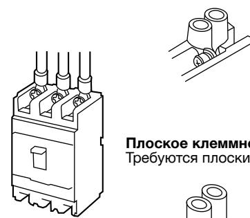
Плоское клеммное соединение
