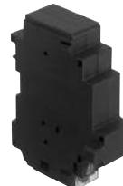
Устройство предназначено для защиты цепей от опасного падения напряжения. Оно также может использоваться для дистанционного управления. Отключение происходит в том случае, если напряжение падает до величины менее 70 % от номинального значения. Выключатель не может быть сброшен до тех пор, пока напряжение не восстановится до величины 85 % от его нормального номинала. См. стр. 80.
