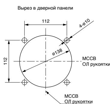
Примечание: Центр отверстия, вырезаемого в панели, следует совместить с центром рукоятки выключателя.
