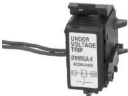
Устройство предназначено для защиты цепей от опасного падения напряжения. Оно также может использоваться для дистанционного управления. Отключение происходит в том случае, если напряжение падает до величины менее 70 % от номинального значения. Выключатель не может быть сброшен до тех пор, пока напряжение не восстановится до величины 85 % от его нормального номинала. См. стр. 80.
