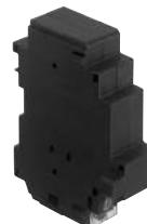
Устройство предназначено для защиты цепей от опасного падения напряжения. Оно также может использоваться для дистанционного управления. Отключение происходит в том случае, если напряжение падает до величины менее 70 % от номин. значения. Выключатель не может быть сброшен до тех пор, пока напряжение не восстановится до величины 85 % от его нормального номинала. См. стр. 169.
