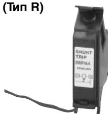
Устройство предназначено для защиты цепей от опасного падения напряжения. Оно также может использоваться для дистанционного управления. Отключение происходит в том случае, если напряжение падает до величины менее 70 % от номинального значения. Выключатель не может быть сброшен до тех пор, пока напряжение не восстановится до величины 85 % от его нормального номинала. См. стр. 169.
