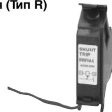
Устройство предназначено для защиты цепей от опасного падения напряжения. Оно также может использоваться для дистанционного управления. Отключение происходит в том случае, если напряжение падает до величины менее 70 % от номинального значения. Выключатель не может быть сброшен до тех пор, пока напряжение не восстановится до величины 85 % от его нормального номинала. См. стр. 169.
