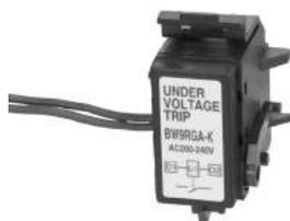
Устройство предназначено для защиты цепей от опасного падения напряжения. Оно также может использоваться для дистанционного управления. Отключение происходит в том случае, если напряжение падает до величины менее 70 % от номин. значения. Выключатель не может быть сброшен до тех пор, пока напряжение не восстановится до величины 85 % от его нормального номинала. См. стр. 80.
