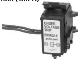
Устройство предназначено для защиты цепей от опасного падения напряжения. Оно также может использоваться для дистанционного управления. Отключение происходит в том случае, если напряжение падает до величины менее 70 % от номинального значения. Выключатель не может быть сброшен до тех пор, пока напряжение не восстановится до величины 85 % от его нормального номинала. См. стр. 169.
