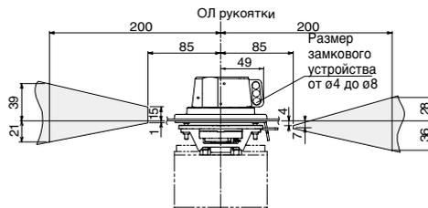
Примечание: Центр отверстия, вырезанного в панели, следует совместить с центром рукоятки выключателя.
